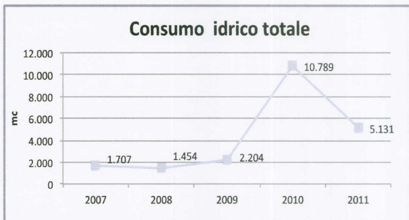
Prendendo i dati di consumo dei primi sei mesi del 2010 in cui si può escludere presenza di perdite e gli ultimi dieci mesi del 2011 e proiettandoli su base annua si possono stimare i consumi reali ed il relativo indice di efficienza del consumo idrico che viene riportato di seguito.
